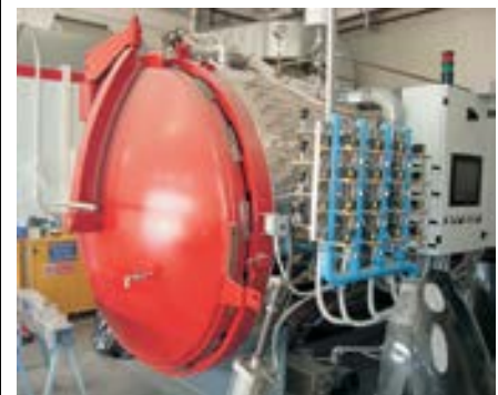
Autoklávy k vytvrzování prepregových částí
